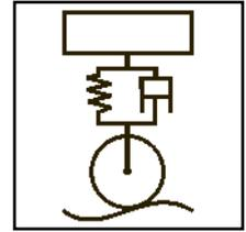
Anhand der beschriebenen Schwingungen werden Bewertungsverfahren aufgezeigt, mit deren Hilfe der Schwingkomfort von Schienenfahrzeugen, die Sicherheit (dynamische Radaufstandskraft) sowie die Gleisbeanspruchung bestimmt und bewertet werden können. Mit diesem Wissen wird auf das realitätsnähere Zweimassenschwingermodell übergegangen und der Konflikt zwischen der Fahrwerksauslegung auf optimalen Fahrkomfort und auf optimale Fahrsicherheit erläutert.
