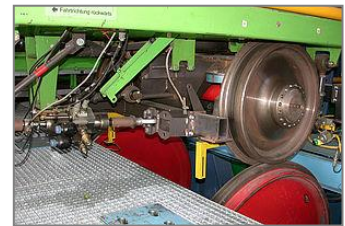
Rollprüfstand für Untersuchung zur Sicherheit gegen Entgleisung
