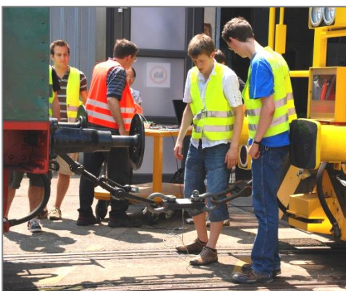
Studierende bei der Zugkraftmessung
