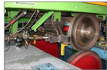
Rollprüfstand für Untersuchung zur Sicherheit gegen Entgleisung
