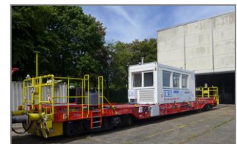
Erprobungsträgerfahrzeug IFS 1 „CargoMover“
