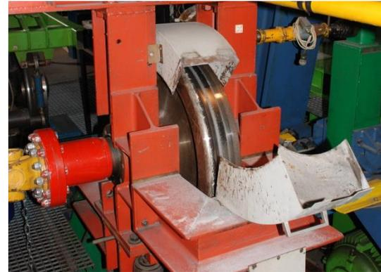
Einzelradrollprüfstand am ifs
