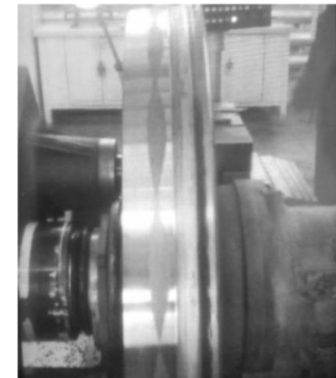
Verschleiß der Radlauffläche
